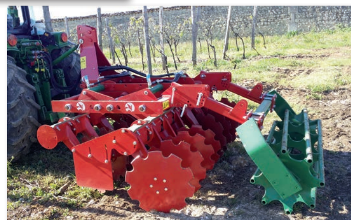
- Minivid: grada rápida especialmente diseñada para viña - Minivid: short disc harrow especially designed for vineyard
