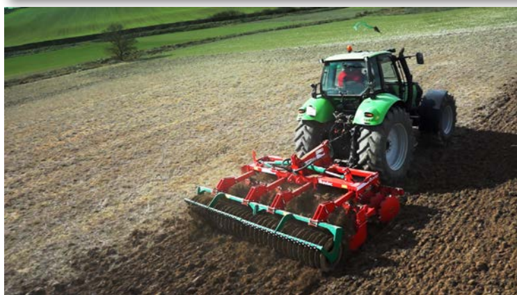
- Gradas rápidas de discos con discos de 20" y 24", de 2,5 a 9 m. - Short disc harrows with 20" or 24" discs and from 2,5 up to 9 m.
